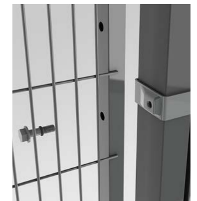
SOPORTE SMART FIX Fijado en posición con un perno desde la parte posterior del soporte. Coloque el perno en la posición lateral para crear una esquina
