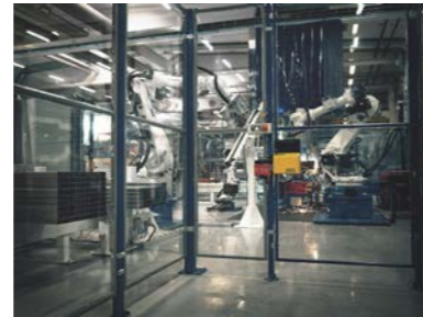
PANELES DE POLICARBONATO Ofrecen buena visión general y protegen contra fluidos y partículas pequeñas.
